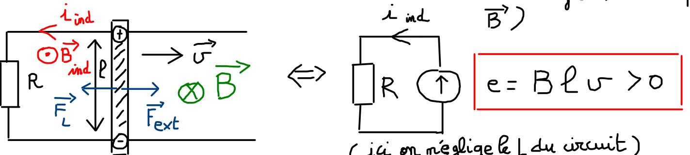
$$P_{elec} = P_{méca} = Blv i \rightarrow \text{Puissance électrique} = \text{Puissance mécanique}$$
