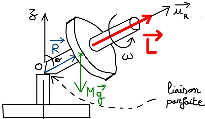
On lance le gyroscope à  $\omega$  autour de son axe de symétrie avec un angle  $\theta$ :
