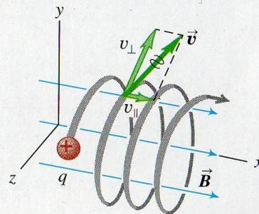
La particule est un proton ( $q = 1,6 \times 10^{-19}$  C,  $m = 1,67 \times 10^{-27}$  kg) et le champ magnétostatique uniforme vaut 0,5 T. Seule la partie magnétique de la force de Lorentz est prise en compte ici (on néglige la gravité et toute les autres forces).
