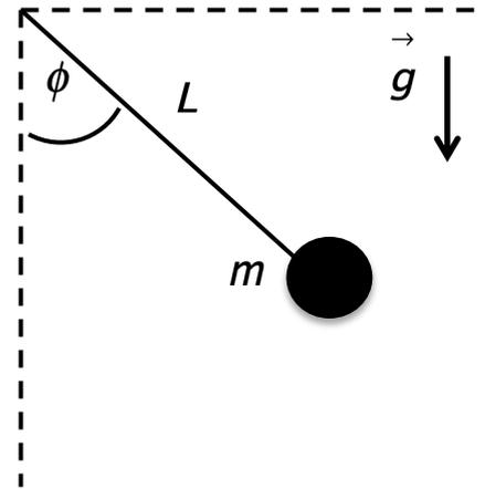
**b)** Nous ne savons pas résoudre analytiquement cette équation différentielle dans le cas général à cause du terme non linéaire  $\sin \phi(t)$ . Nous ne pouvons résoudre cette équation que de façon numérique et on peut montrer que ce pendule dit « simple » possède une dynamique d'une grande richesse et que ce système physique « élémentaire » peut engendrer le « chaos » (cf. TD d'informatique).
