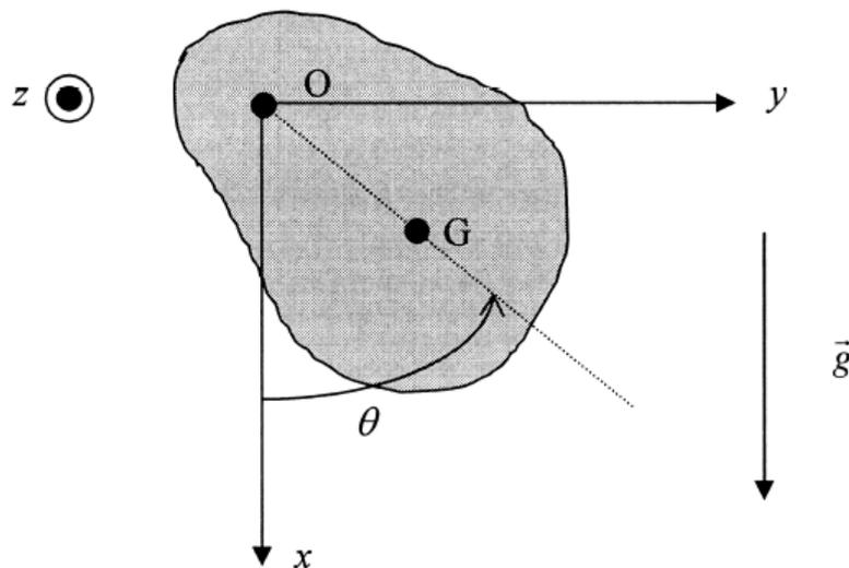
11 – En appliquant le théorème du moment cinétique, déterminer l'équation différentielle vérifiée par l'angle  $\theta$  au cours du temps. En déduire la période  $T$  des petites oscillations du pendule autour de sa position d'équilibre, repérée par  $\theta = 0$ . On exprimera  $T$  en fonction de  $J$ ,  $m$ ,  $a$  et  $g$ .
